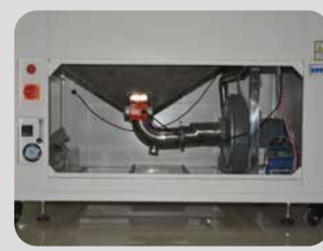
循环风机系统
